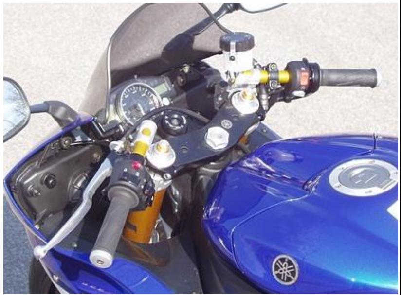
**Carénage et bulle restent inchangés. La butée de direction n'est pas limitée.**
